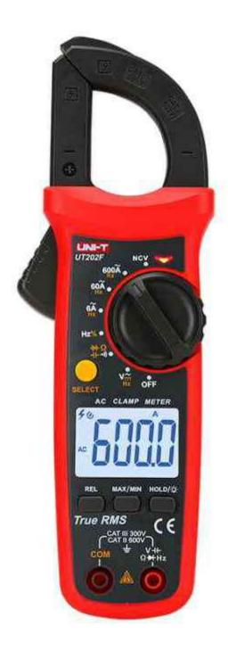
La Electropinza UT202F está diseñada para medir corriente AC y voltaje AC/DC, resistencia, capacitancia, frecuencia, chequea continuidad de circuitos y diodos. Es de auto rango, tiene una apertura de boca de 28mm. y un display máx. de 6.000.
