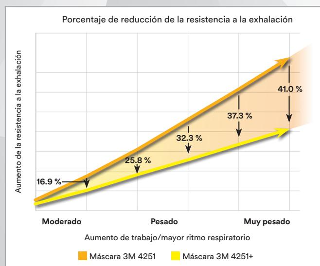
\* A un ritmo de trabajo mayor. Resultados medidos por 3M en 2017 en condiciones de laboratorio. El gráfico muestra la resistencia a la respiración de exhalación por índice de respiración de la máscara 3M 4251 comparada con la máscara 3M 4251+.
