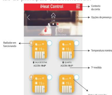
O APP possui ajuda básica no ícone “ajuda” localizado na parte inferior esquerda da tela. Também em determinadas telas do aplicativo, como alterações de temperatura ou programação, o ícone de ajuda mostrará as partes específicas para aquela determinada opção.
