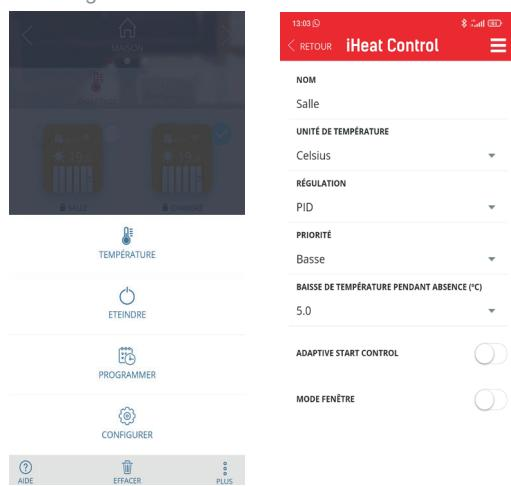
La centrale éteindra d'abord les radiateurs de priorité inférieure, sauf si la différence entre la température de consigne et la température de mesure est considérable, afin de garantir une température adéquate dans toutes les instances de la maison. Dans l'écran de configuration, vous pouvez également modifier le nom de l'équipement, les unités de température ou le type de commande de chauffage.
