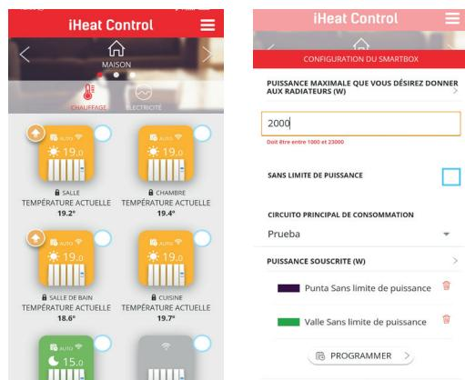
Si vous souhaitez établir une priorité pour les radiateurs (Faible, Moyen ou Élevé), celle-ci peut être configurée dans les options de chaque radiateur, pour cela cliquez sur l'icône de l'appareil, puis sur “plus” et “configurer”.
