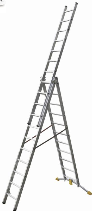
**FR** Echelle transformable 3 plans en aluminium polyvalente - Compensation des inégalités du sol jusqu'à 15cm grâce à une large base rapportée incurvée et au système pédale - Utilisable en échelle simple, double et coulissante - Rattrapage de niveau dans les escaliers pour les modèles 3x8 et 3x9 - Crochet de verrouillage de sécurité - Echelons striés sur les 4 faces - Patins avec large surface de contact au sol antidérapants
