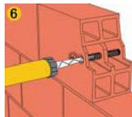
Inyectar el adhesivo en la manga perforadora, a partir de la parte inferior, mientras va retrocediendo el mezclador estático. Evitar la entrada de aire.
