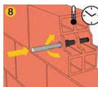
Insertar el anclaje con un movimiento rotatorio en la perforación. Utilice el tamaño de la barra de acero adecuada.
