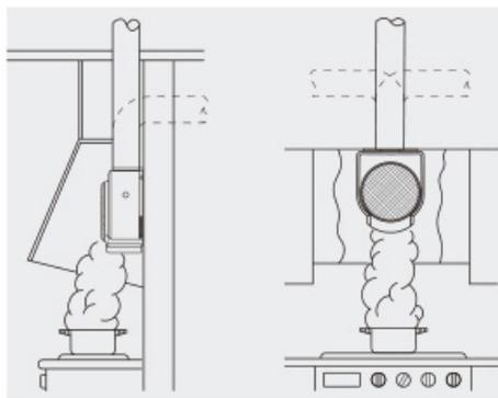
Para obtener el máximo rendimiento de un extractor de cocina, deberá ser instalado dentro de una campana de captación. Es recomendable que la base de la campana de captación supere ligeramente la de la superficie de cocción. Los extractores se instalan de forma vertical para permitir la recogida de grasas en la bandeja de la base.
